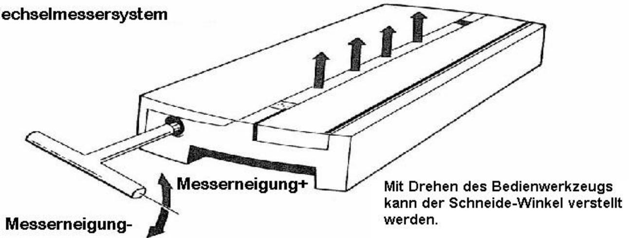
Im Vergleich zum Vorgängermodell erhöht sich mit diesem System die Standzeit des Messers erheblich, da es bei Ausstumpfen angestellt werden kann.
